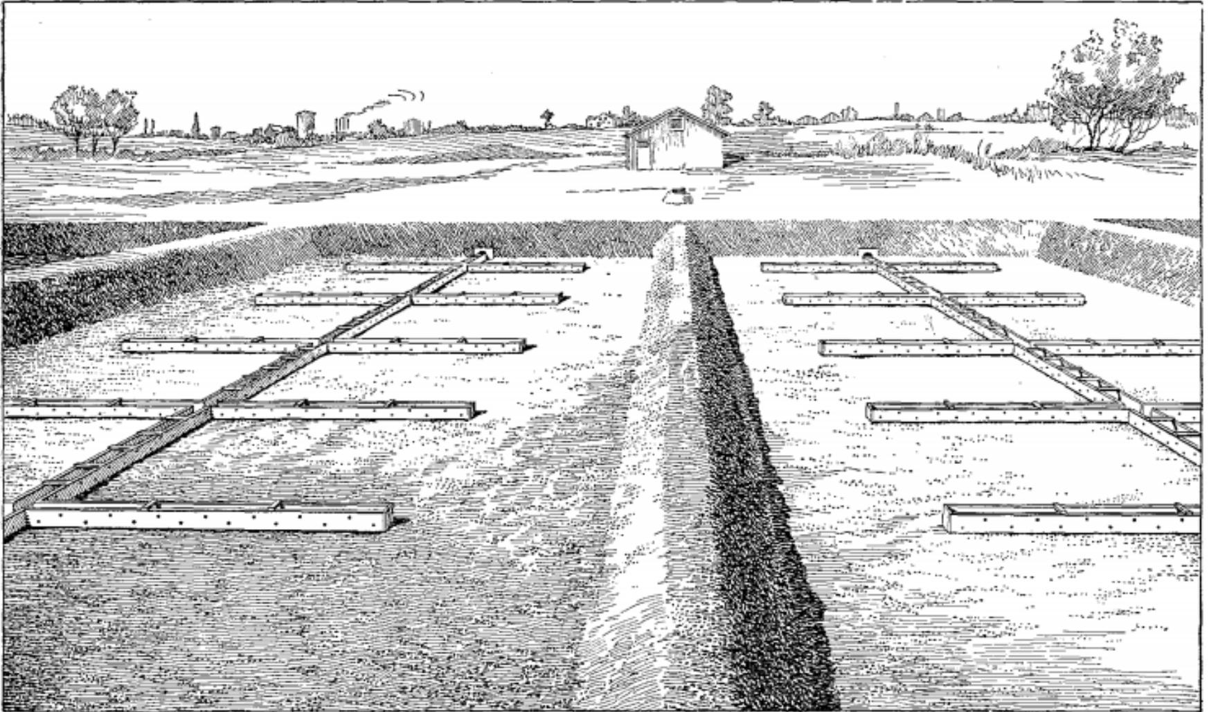
FIG. 133. DISTRIBUTION SYSTEM FOR INTERMITTENT SAND FILTRATION.
